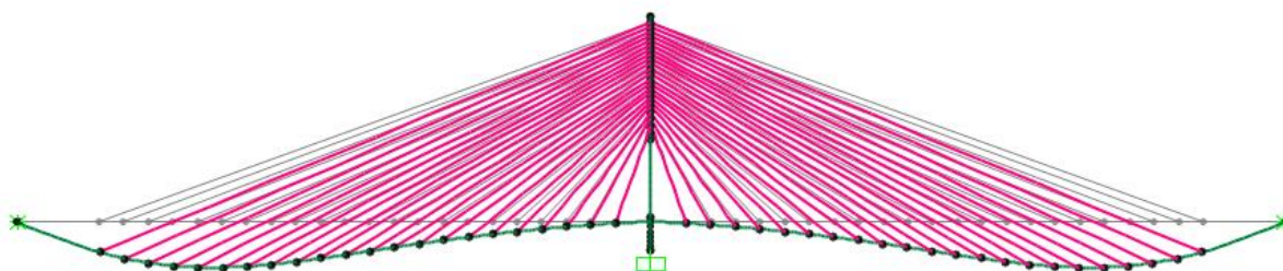
Figura 7.8: Deformada devido a carga de multidão.
