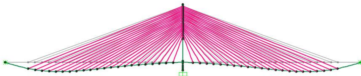
Figura 7.2: Deformada em relação ao peso próprio
